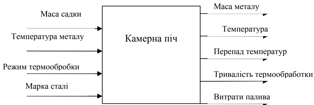
Рис. 1. Схема інформаційних потоків камерної печі
